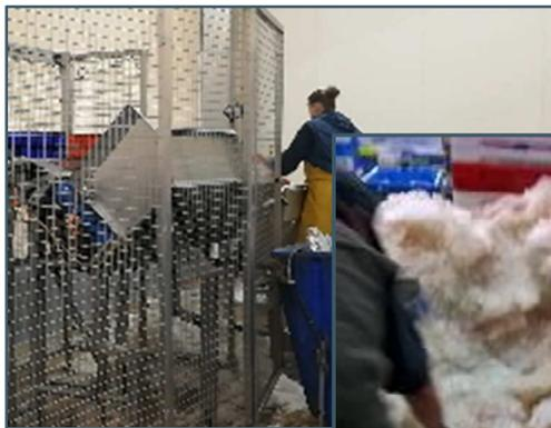
Certaines halles à marée ont une machine de pré tri avec un dispositif permettant d'évacuer la glace des bacs. La glace se retrouve à même le sol et fond.
