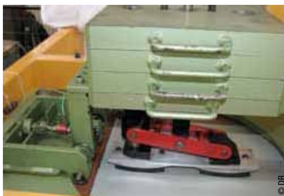
Banc d'essai pour mesurer le coefficient de frottement dynamique en laboratoire
