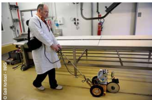
Le P.F.T (Portable Friction Tester)
