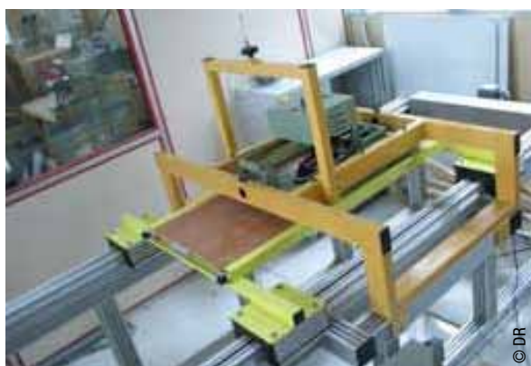
Banc d'essai pour mesurer le coefficient de frottement dynamique en laboratoire
