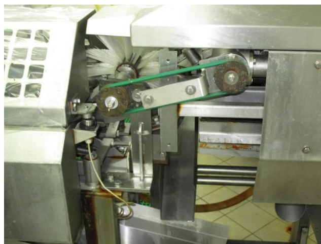
Organes en mouvement accessibles sur une fileteuse ancienne
