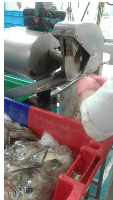
Trancheur avec capot protecteur absent
